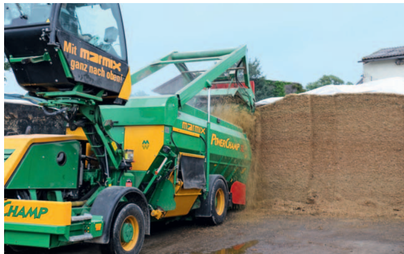
Die Landwirte waren sich schnell bei der Technik einig. Als Kriterien nennen sie die wenig störungsanfällige Zuführung beim Fräsen, die gute Mischqualität und die schwenkbare Fahrerkabine.
